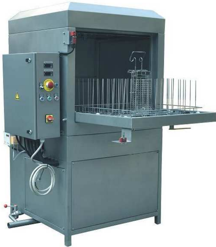
Messerkorbwaschmaschine Frontlader für 16 -18 Körbe Dampf
