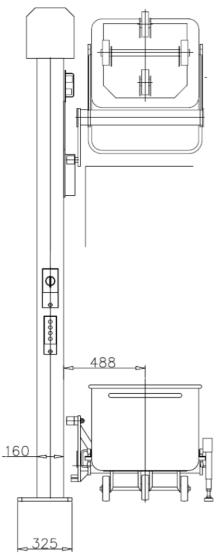
3 x 400/ 50 Hz 24 V AC 0.75 kW IP 65 5 m/min 937 mm 325 mm 1.013mm 3.990 mm 576 3990 260 3050 445 937
